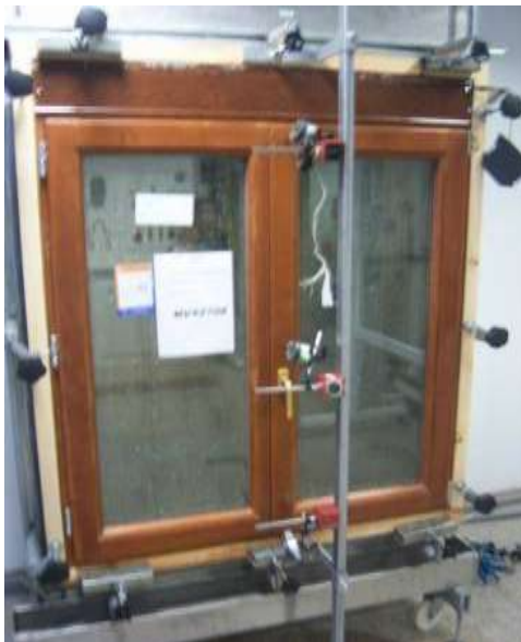
Zona determinación de la flecha
